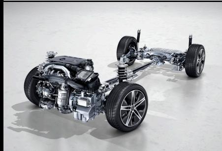
La nueva GLB 250 incluye Tracción Integral Permanente (4MATIC), lo cual lleva las cuatro ruedas acopladas a la transmisión del motor. Así, brinda mayor agarre y control en ciertas condiciones de la carretera, agregando deportividad al vehículo y mejor versatilidad en terrenos difíciles.
