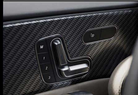
Paquete de memorias del ajuste de asientos hasta para 3 personas diferentes, además de poder modificar la posición del asiento de forma eléctrica. Disponible únicamente para el asiento del conductor.
