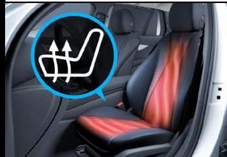
La calefacción de asiento ajusta con rapidez una temperatura agradable de los asientos del conductor y del copiloto. La intensidad se selecciona en 3 niveles. Transcurrido un tiempo, la calefacción de asiento cambia automáticamente a un nivel más reducido.
